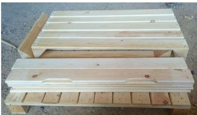
Контейнер размером 1120x1120x770мм, изготовленный из сухого строганного пиломатериала хвойных пород, сосна/ель, сорт 1-2. Толщина боковых досок 20мм, углы закруглены. Все детали строганные – калиброванные. В зависимости от конструкции контейнера внутри крепится стальной уголок 2 шт., или снаружи 4 уголка из оцинкованной стали толщиной 0,7мм. Вместимость яблок 300-350кг. Штабелирование 7-10 ярусов.
