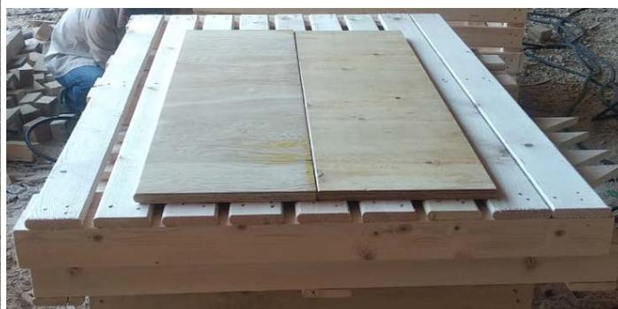
Контейнер размером 1600x1200x1230мм, изготовленный из сухого строганного пиломатериала хвойных пород, сосна/ель, сорт 1-2. Наружный размер с поддоном 1600x1200x1200 мм. Внутренний размер 1070x1180x1180мм. Толщина боковых досок 20мм, углы закруглены. Все детали строганные – калиброванные. В зависимости от конструкции контейнера внутри крепится стальной уголок 2 шт. Вместимость картофеля 1200-1300кг. Штабелирование 6-7 ярусов.
